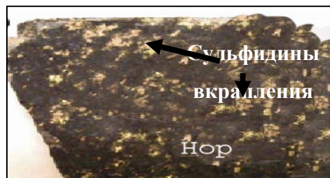
Рис. 2. Образец сульфидной руды Гишунского комплекса, где видны вкрапления сульфидов(светлое) в норите(Нор-темное).
